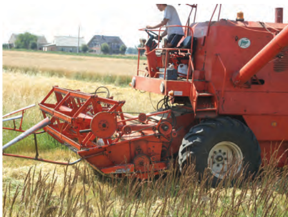
Brak osłon mechanizmów napędowych i przewóz osób na drabinkach i pomostach to poważne zagrożenie
