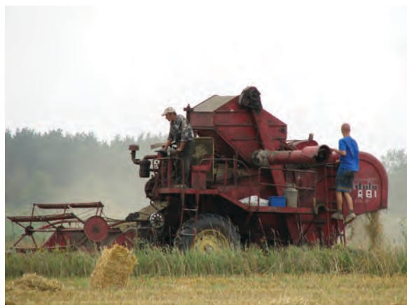
Brak osłon mechanizmów napędowych i przewóz osób na drabinkach i pomostach to poważne zagrożenie
